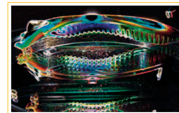
Controlul de calitate al aparatelor de ras - cap și lame
